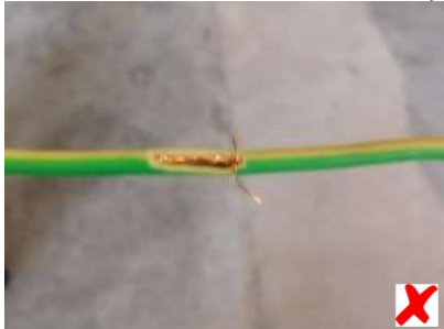
Uszkodzony kabel uziemiający
