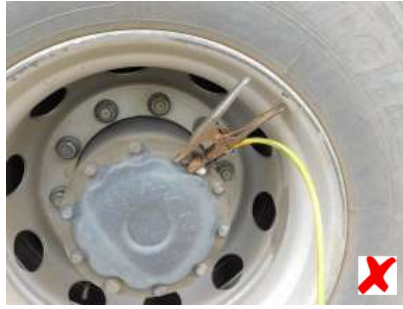
Заземлення на колесо АС
