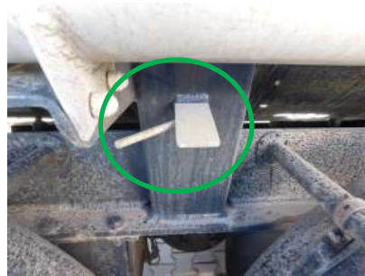
tartálykocsi földelő pont
