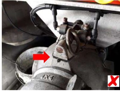
Szelep nem megengedett rögzítése
