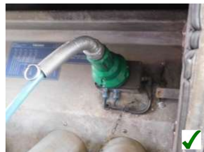
CIVACON csatlakoztatása a tartálykocsihoz
