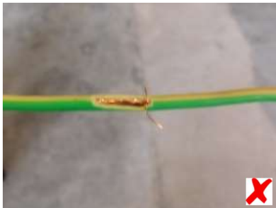
Sérült földelő kábel
