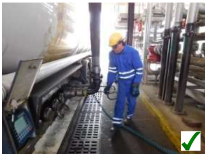
Egyéni védőeszközökkel felszerelt járművezető a töltés közben
