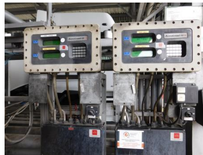
Přihlášení na ACCULOAD, navolení množství produktu do jednotlivých komor
