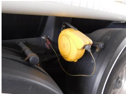
Zemní bod cisterny
